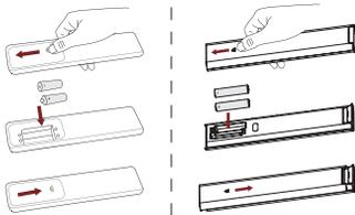
1. Öffnen Sie das Batteriefach der Fernbedienung.
